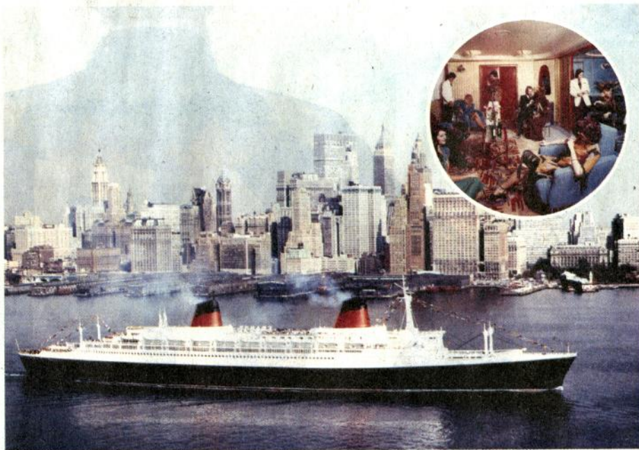
Ce paquebot d'exception de 315 m de long, entraîné par 160 000 chevaux, est lancé en mai 1960.
